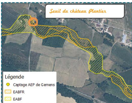
Dans le cadre de la non valorisation économique de l'ouvrage, de l'impact de l'ouvrage sur la continuité biologique et de l'absence d'enjeux géotechniques significatifs en amont de l'ouvrage, le scénario d'arasement a été retenu afin d'assurer un gain maximal en terme de restauration hydromorphologique, dans un secteur où la Gère présente une mobilité intéressante
