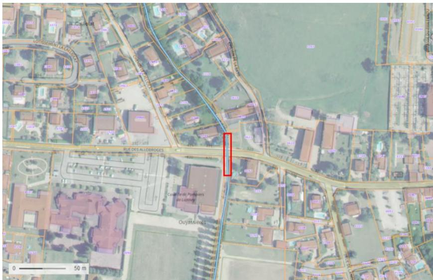
Le pont des Allobroges est un ouvrage voûte qui présente une ouverture de 2 m de largeur, pour une hauteur max. de 1m. La cote de surverse sur la voirie est de 222.85 mNGF
