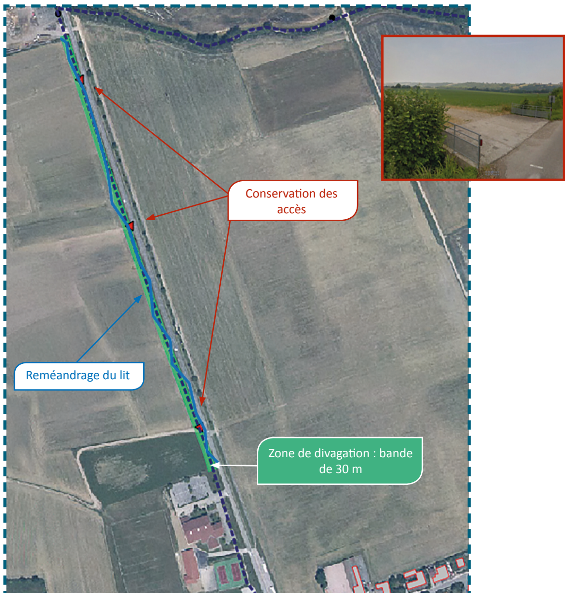
Exemple de préservation du lit mineur et des berges sur un ruisseau par pose de clôtures
