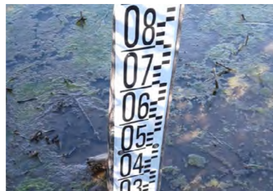
Échelle limnimétrique pour la campagne de mesure et de suivi hydrologique des zones humides
