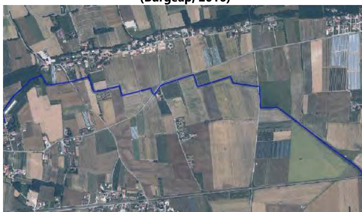
Figure 19 : Tracé rectiligne à angles droits de l'Oron dans la partie aval de la plaine de la Valloire (Burgeap, 2016)
